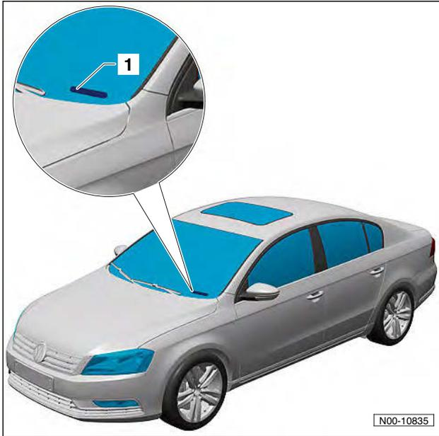
Die Fahrzeug-Identifizierungsnummer (Fahrgestellnummer) lässt sich von außen durch ein Sichtfenster –1– in der Frontscheibe ablesen. Das Sichtfenster befindet sich unterhalb vom linken Scheibenwischer.
