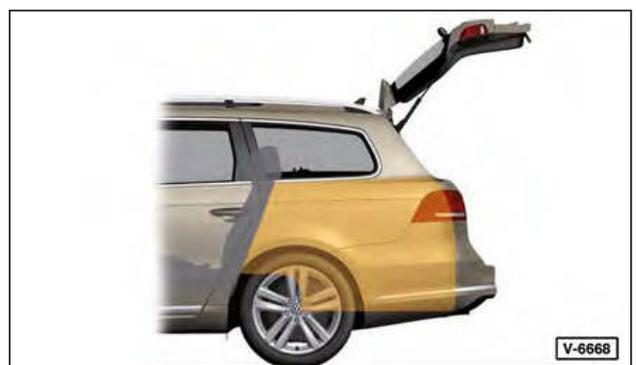
Die große Heckklappe des PASSAT VARIANT schwenkt auf Wunsch mit elektrischer Motorkraft nach oben.
